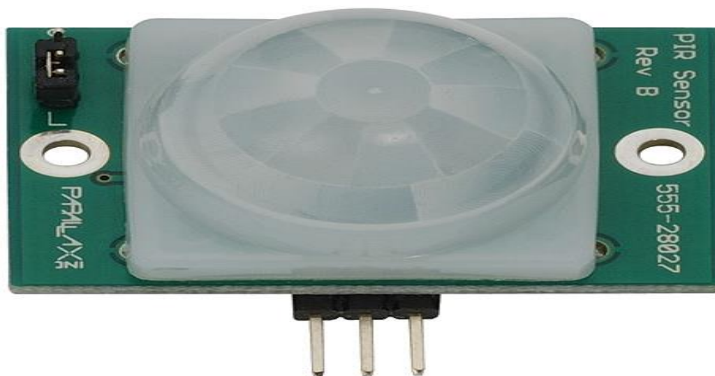
Εικόνα 3.2.1 Ο ανιχνευτής κίνησης.
