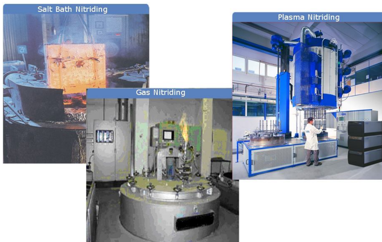
Σχήμα 8: Εμπορικές τεχνολογίες για την διαδικασία της εναζωτωσης, εναζώτωση σε λουτρά αλάτων, σε φυσικό αέριο και εναζώτωση πλάσματος.
