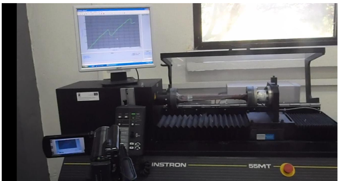
Πείραμα στρέψης ενός δοκιμίου στην μηχανή στρέψης Instron 55MT2
