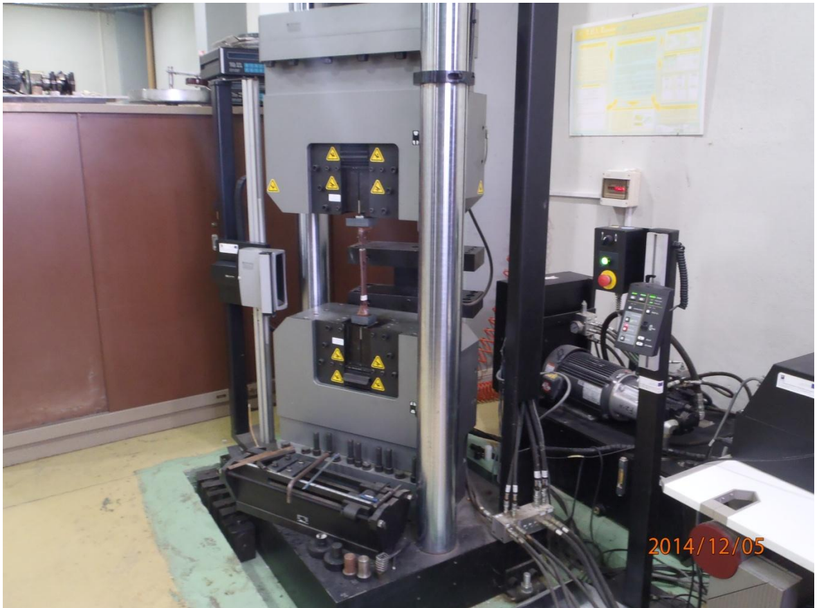
Στατικό πείραμα ενός δοκιμίου στην μηχανή στατικής θλίψης Instron KN1200
