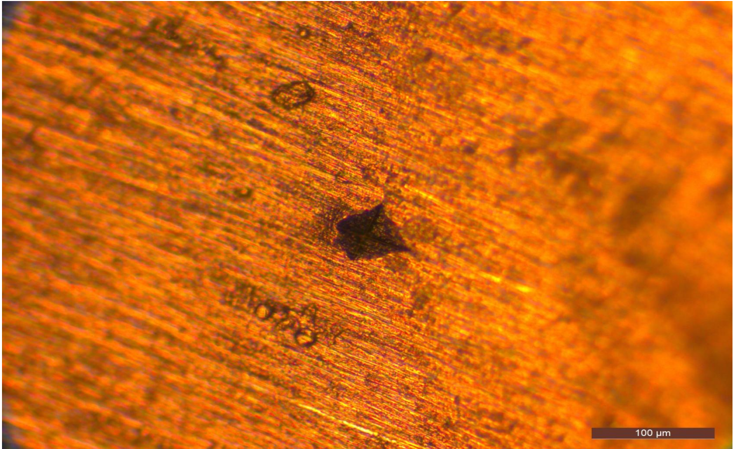
Εικ. 5.4 Αποτύπωμα σκληρομέτρησης Vickers σε αλουμίνιο
