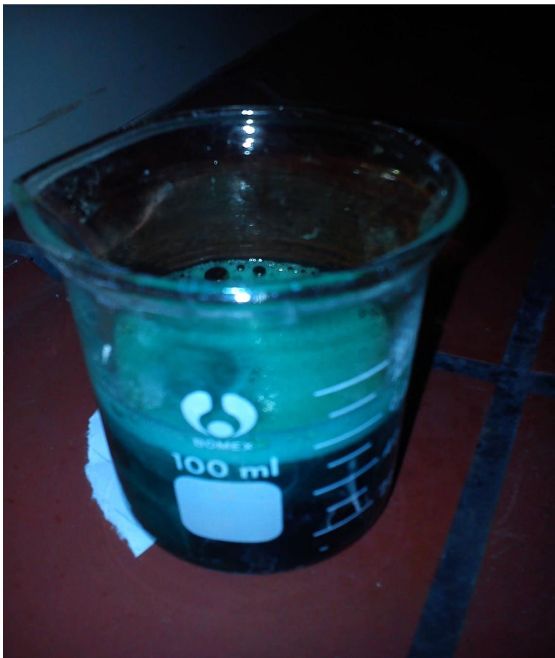
Εικ. 4.3 Παραγωγή φυσαλίδων από δοκίμιο χαλκού σε νιτρικό οξύ 50%
