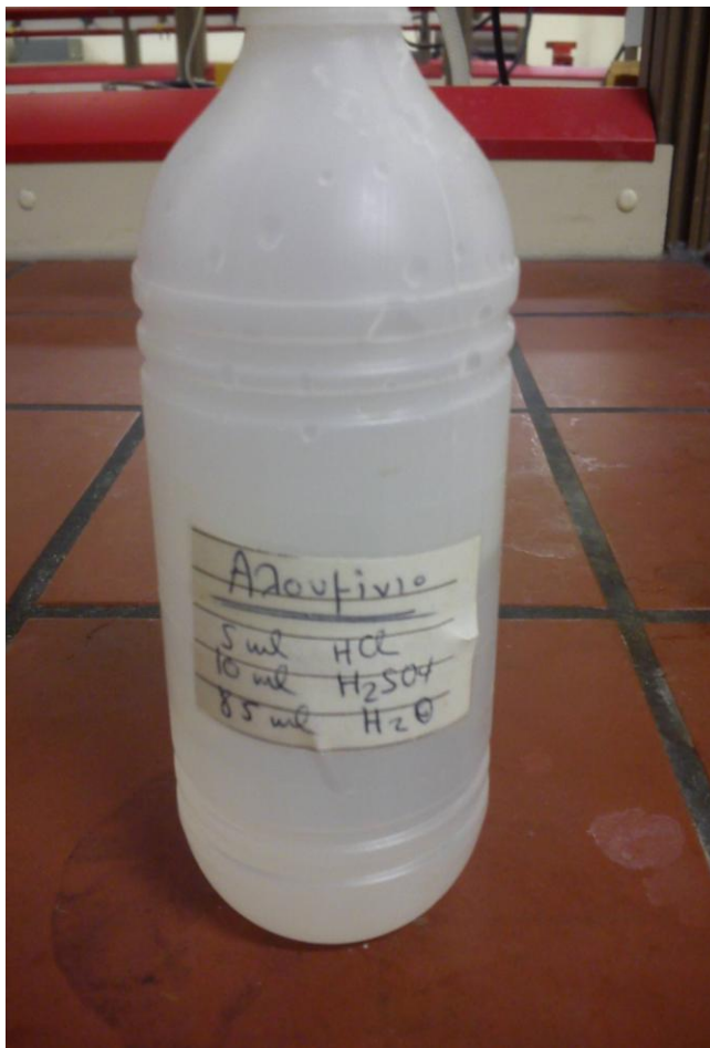
Εικ. 4.1 Περιέκτης του αντιδραστηρίου που χρησιμοποιήθηκε για το αλουμίνιο (αριστερά) και του αντιδραστηρίου Nital, κατάλληλου για σιδηρούχα υλικά, που χρησιμοποιήθηκε για τον χάλυβα (δέξια)
