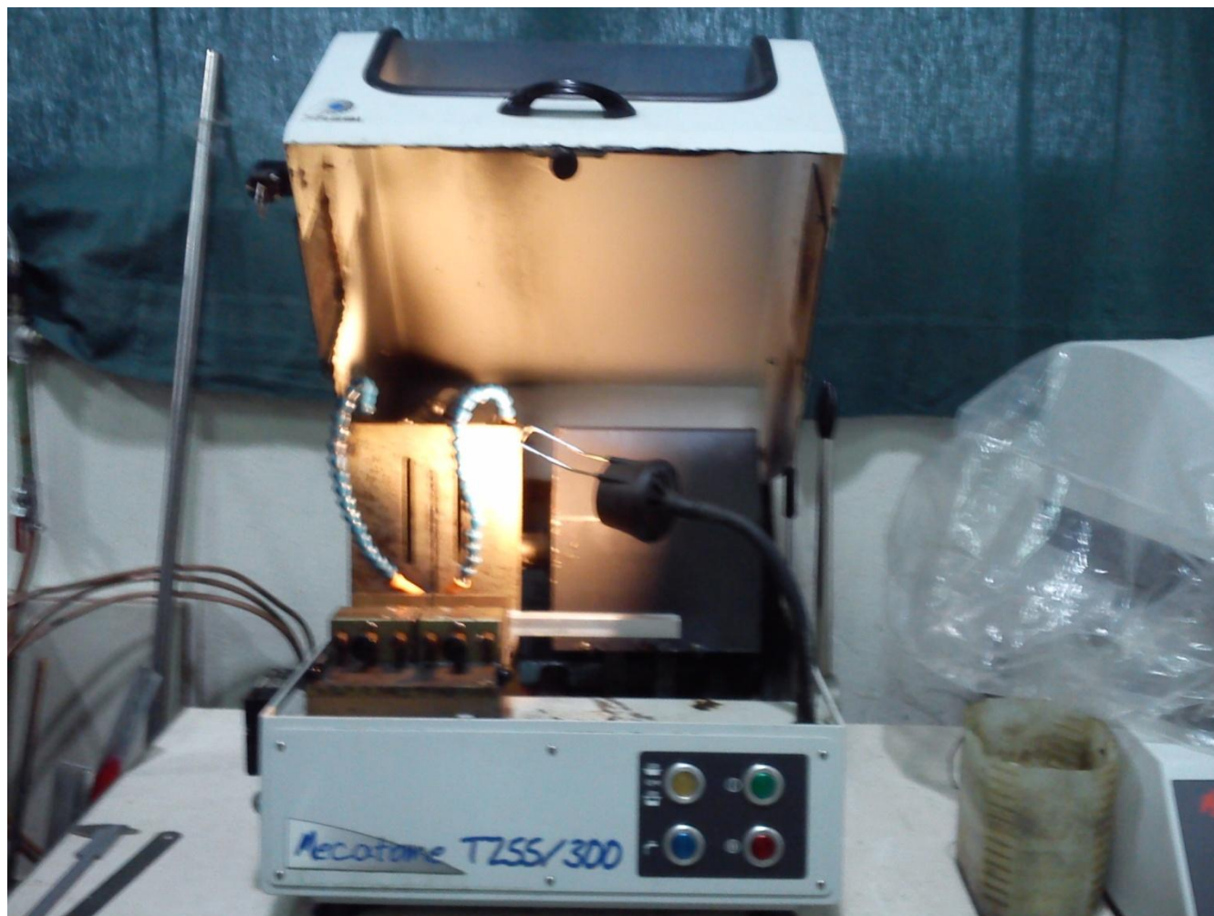
Εικ. 2. 3 Υδρόψυκτος τροχός κοπής τύπου Mecatome TZ 55/300 της εταιρίας Presi, με ανοιχτό κάλυμμα.
