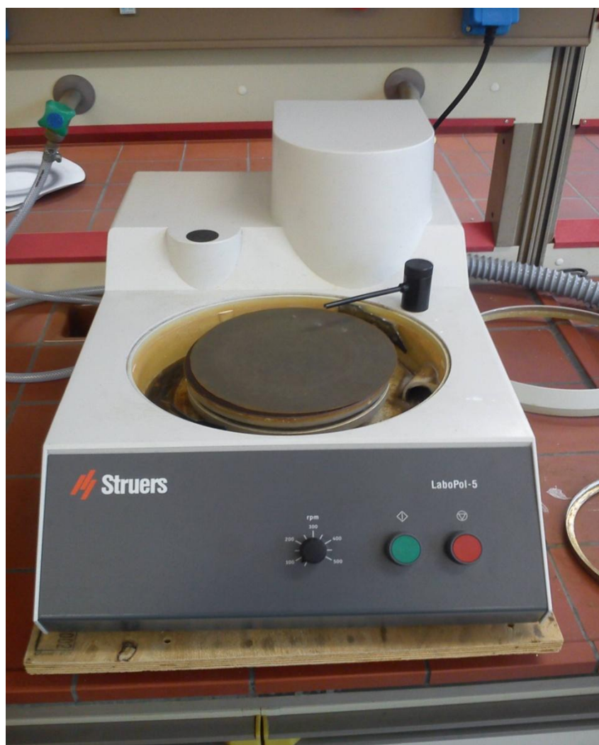
Εικ. 2. 12 Μηχάνημα λείανσης τύπου Labopol-5
