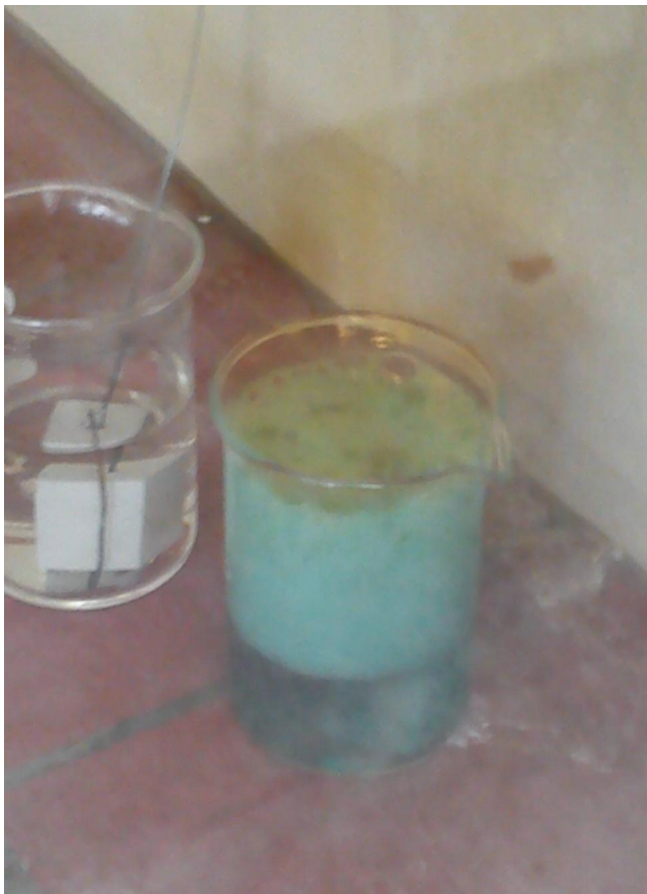
Εικ. 4.2 Παραγωγή φυσαλίδων αμέσως μετά την τοποθέτηση δοκιμίου από ορείχαλκο σε νιτρικό οξύ 50% (δεξιό δοχείο) και δοκίμιο αλουμινίου εμβαπτισμένο στο αντίστοιχο αντιδραστήριο (αριστερό δοχείο)
