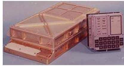
Εικόνα 1.1: Apollo Guidance Computer και DSKY (οθόνη και πληκτρολόγιο) [1]
