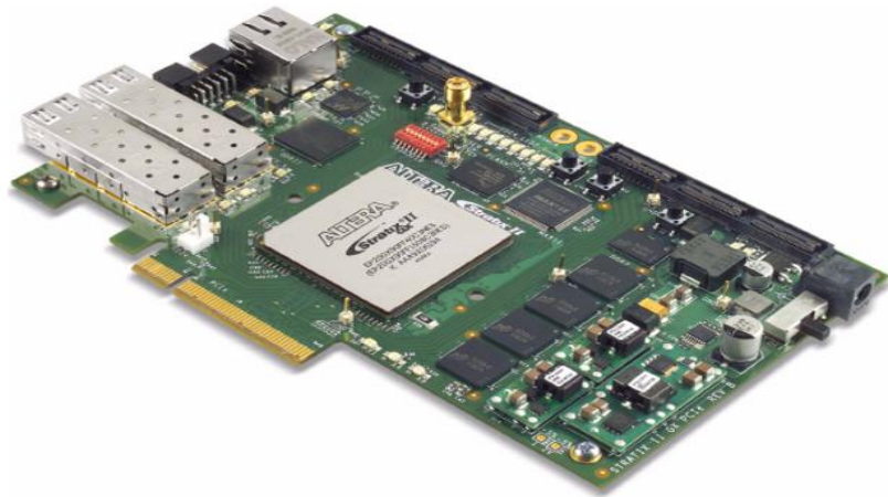
Εικόνα 1.11: Αναπτυξιακή πλακέτα Stratix II GX PCIe της εταιρείας ALTERA. [8]
