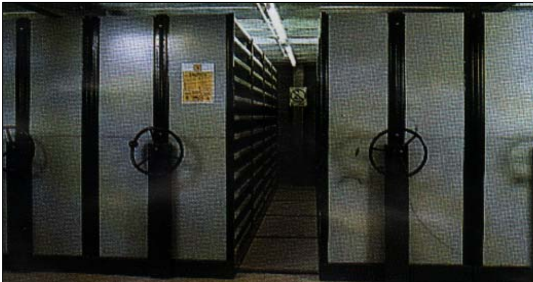
Εικόνα 2.8.β. μηχανική μέθοδος μετακίνησης
