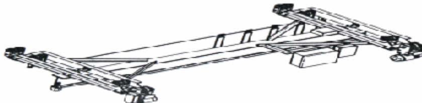
Εικόνα 6.8.3.ε. Κρεμαστή γερανογέφυρα απλού φορέα, διπλού μοτέρ κύλισης
