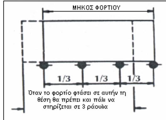
Εικόνα 5.3.1.2.α. Κάθε στιγμή πρέπει τουλάχιστον τρία ράουλα να βρίσκονται σε επαφή με το φορτίο
