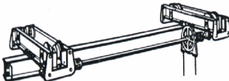
Εικόνα 6.8.3.δ. Τυπική χειροκίνητη αλυσωτή κρεμαστή γερανογέφυρα
