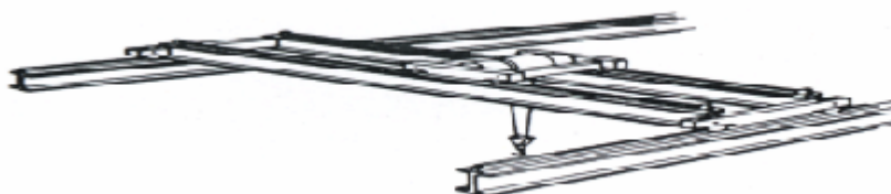
Εικόνα 6.4.4.ε. Γερανογέφυρα βαρέος τύπου διπλού φορέα
