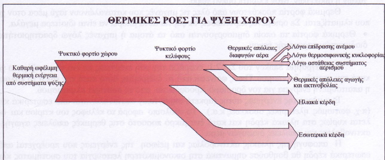
Σχήμα 2.1.- Ροή ενέργειας σε κλιματιζόμενο χώρο (για ψύξη χώρου)
