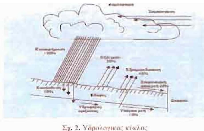
Σχ. 2. Υδρολογικός κύκλος
