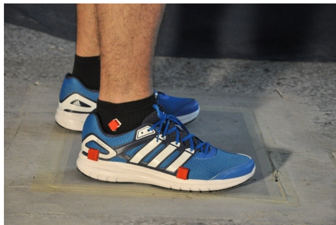
Εικόνα 23:Τοποθέτηση στον αθλητή αυτοκόλλητα-ανακλαστήρες διαμέτρου 0,5 εκ
